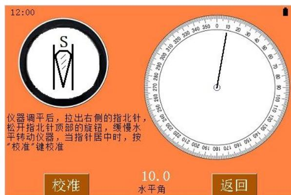
先松开指北针顶部的止动螺丝，再松开主板壳体底部的水平止动螺丝，缓慢转动仪器，观察管式指北针的指针居中后，点击屏幕的“校准”按钮，方位角就校准完成了。
