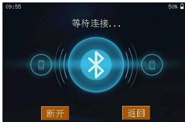
在蓝牙页面，点击“打开”按钮，然后在其它终端打开蓝牙并连接本机 (CH914BLE2U)，连接成功后就可以向外发送数据了。
