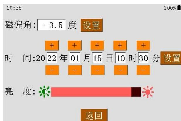
在设置页面，输入需要的磁偏角后点击“设置”按钮；修改实时时间后点击“设置”按钮；拖动亮度滑块调整屏幕亮度。
