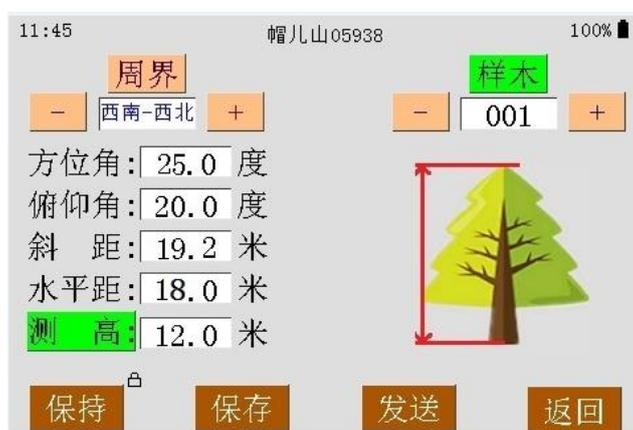
**周界测量：**点击“周界”按钮，通过按钮下方的“+”“-”选择当前的测量方向。缓慢转动仪器并观察方位角的数值，当方位角的读数为所需角度时，将水平止动螺丝锁紧，通过仪器上部的激光测距瞄准目标并按“测量”键测距。
